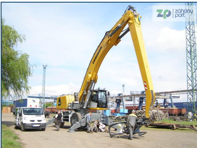
A Liebherr-Material Handler LH 50M forgórakodó beüzemelés közben.
