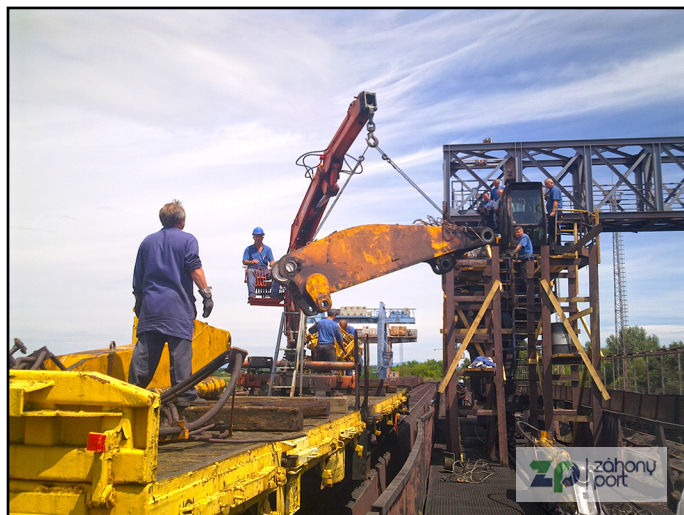
Az 1700 kg-os gémszerkezet kiemelése
