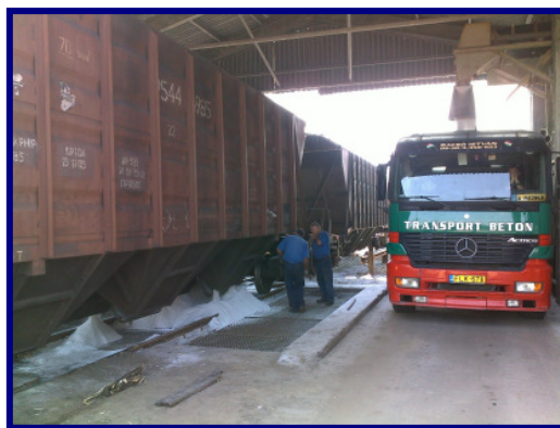
Ömlesztett só átrakása a Csigás2 átrakó-berendezésen
